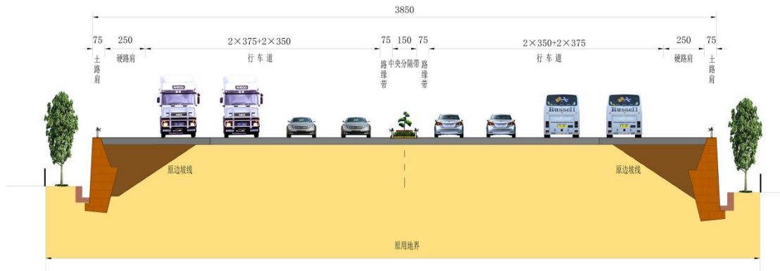
图 5: 成彭高速扩容全线设置路肩墙收坡
