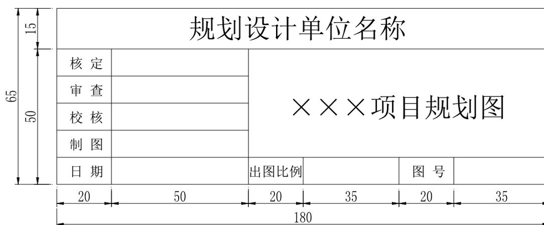
图 7-1 规划图图签
