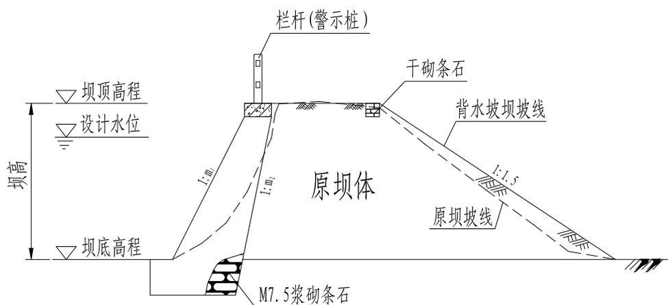
图 4-1 挡土墙式塘坝断面设计示意图
