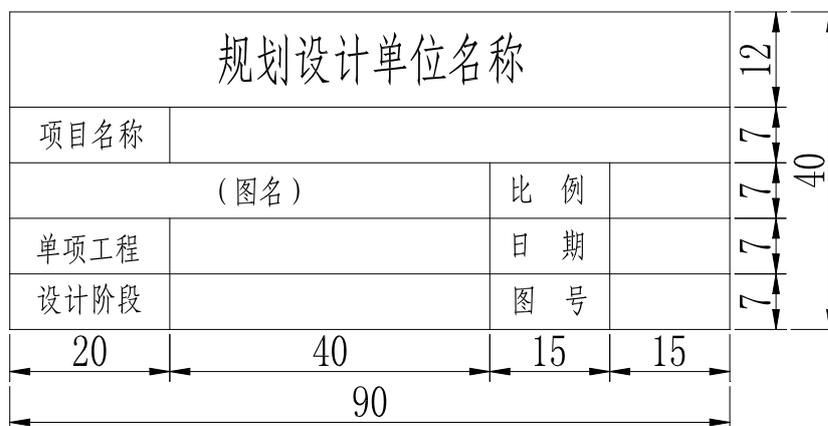
图 7-2 单项工程设计图标题栏
