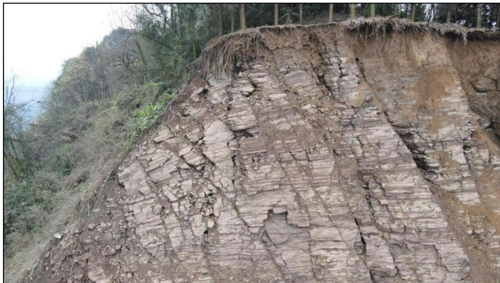
图 4 岩体节理裂隙发育（斜坡顶部）
